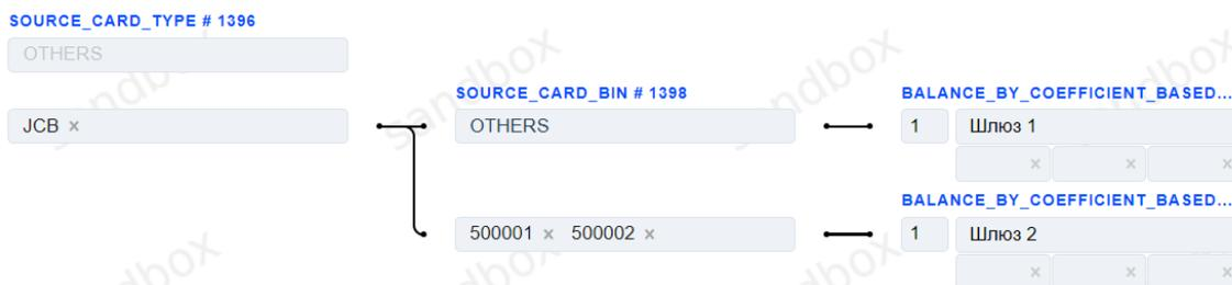
Рисунок 205 - пример настройки стратегии для банковских карт платёжной системы JCB с разбивкой маршрута по BIN карт и направлением транзакций в два различных шлюза.
